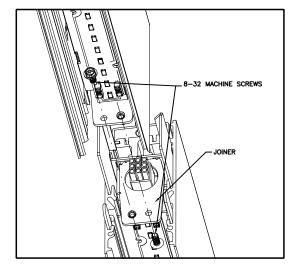
PUSH EXCESS POWER CONNECTOR CABLES BACK INTO FIXTURE THROUGH JOINERS AS SHOWN FOR MLS-2 OR TO EITHER SIDE OF JOINER FOR MLS-3 -SECURE FIXTURES TOGETHER USING (2) 8-32 SCREWS THROUGH JOINER AS SHOWN ABOVE (PROVIDED BY MERCURY). -Repeat step 4 & 5 ás needed until 'end' MODULE IS INSTALLED.
